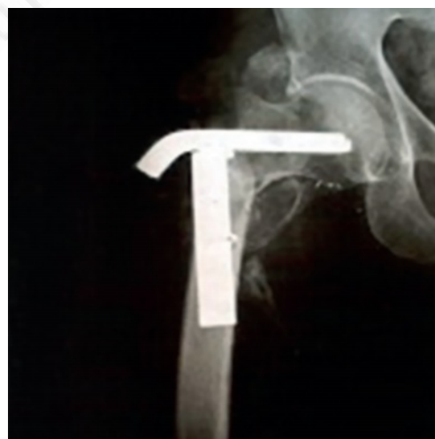
Fig. 132.4. Ruptura del material por fatiga.
