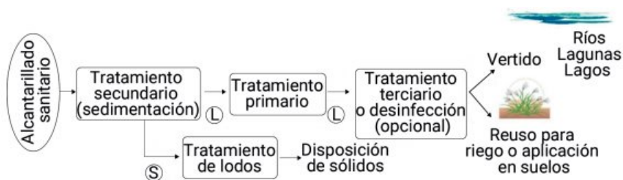
Fig. 35.2. Componentes de un sistema de tratamiento de residuales líquidos.
