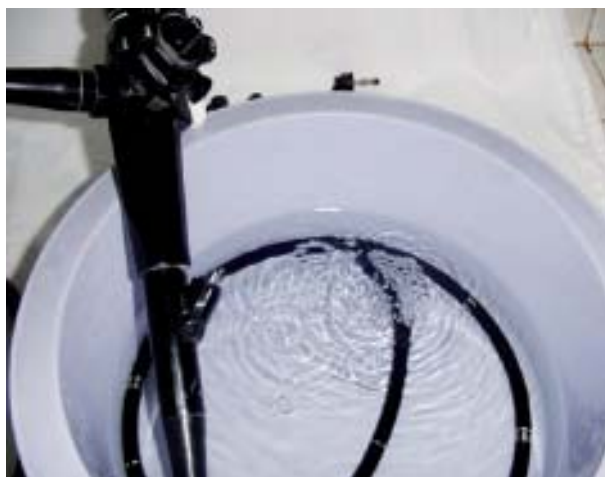
Figura 3.10. Equipo perforado. Observen salida de burbujas por su porción distal.
