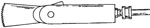
Fig. 8.4 Esta sierra mecánica oscilante imprime a la hoja un movimiento de segmento circular limitado.
